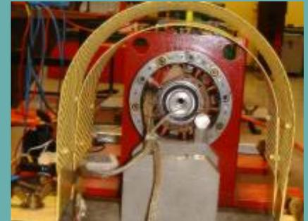
*L'alternateur est monté sur un banc qui permet la rotation du rotor (à l'extérieur) tout en immobilisant le stator (à l'intérieur). Une protection a été montée sur le banc pour se prémunir d'une éventuelle satellisation de l'alternateur. 😊*
