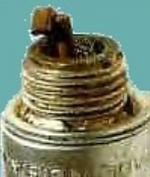
Cette bougie est déformée et a certainement reçue un choc. Quelque chose dans le cylindre a heurté et déformé l'électrode de masse, ce problème doit être impérativement réparé avant de refaire tourner le moteur. Vérifiez si c'est le bon modèle de bougie et si ses dimensions sont compatibles avec ce moteur.
