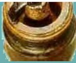
Préallumage qui a commencé à faire fondre l'électrode centrale ou/et celle de masse. Vérifier la classe de température de la bougie, le réglage de l'avance à l'allumage, si le mélange n'est pas trop pauvre ou rechercher des points chauds ou des zones calaminées dans la culasse.
