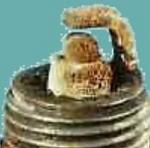
Cette bougie est calaminée par un dépôt de couleur brun clair qui recouvre l'électrode de masse et/ou l'électrode centrale. Cette contamination provient du type d'huile ou des additifs utilisés. Il en découle un allumage dégradé. Un changement de type d'huile entre deux révisions générales peut aussi en être la cause.
