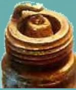
Cette bougie est complètement usée, elle a de nombreuses heures de service. Remarquez comme l'électrode centrale est arrondie et usée par les heures de fonctionnement. Pour amorcer, une bougie usée demande une tension plus élevée et cela induit une baisse du rendement du moteur.
