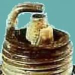
Une détonation trop violente a causé la cassure de la porcelaine isolante. Si le moteur continue à être utilisé il pourrait être endommagé. Assurez vous que le taux d'octane du carburant utilisé est suffisamment élevé et conforme aux spécifications de ce moteur.
