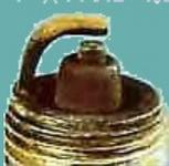
Un dépôt noir et duveteux colorant la bougie est causé par un réglage de carburation trop riche ou un ralenti trop bas sur certains moteurs. Des fumées noires à l'échappement est le signe d'un mélange trop riche. La richesse de la carburation doit être rectifiée avant de changer de bougies. Les principales causes d'un excès de richesse à la carburation sont :
