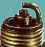
Cette bougie est saturée d'huile, qui peut-être causé par un mauvais contrôle du dosage. Ce phénomène se produit aussi après une période longue d'inactivité lorsque les moteurs sont installés tête en bas (bougies).
